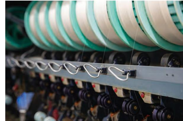
Afin de préserver l'ondulation naturelle du fil bavé par le ver à soie, les fils sont dévidés lentement par le métier à filer.
