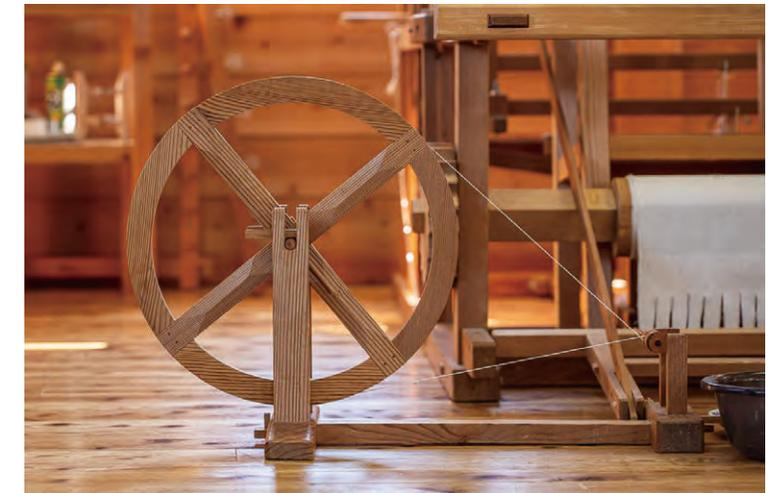
Rouet posé au pied d'un métier à tisser. On l'utilise notamment pour la préparation du fil de trame, enroulé sur une canette insérée dans la navette.
