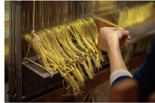
Les fils de chaîne sont passés dans les œillets des lisses. Les lisses permettent d'ouvrir un passage entre deux nappes de fils de chaîne.
