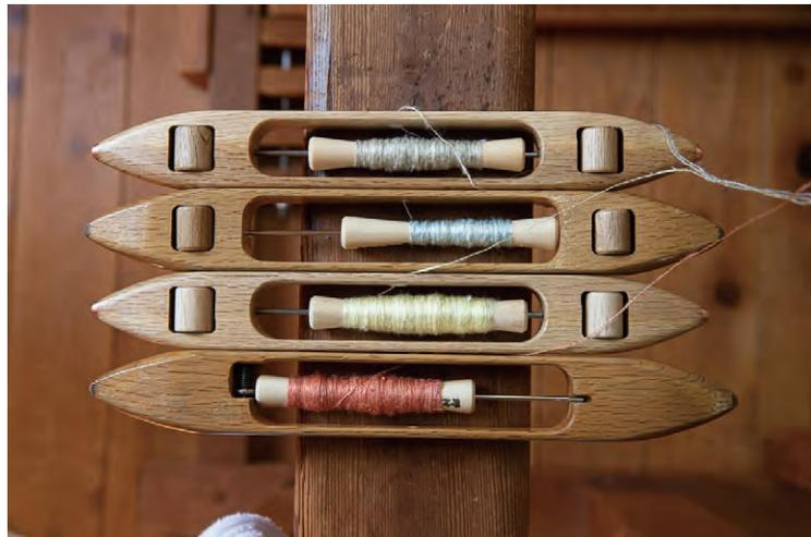
Navettes, éléments de métier à tisser, utilisées pour passer les fils de trame (transversaux) entre les fils de chaîne (longitudinaux) du tissu.
