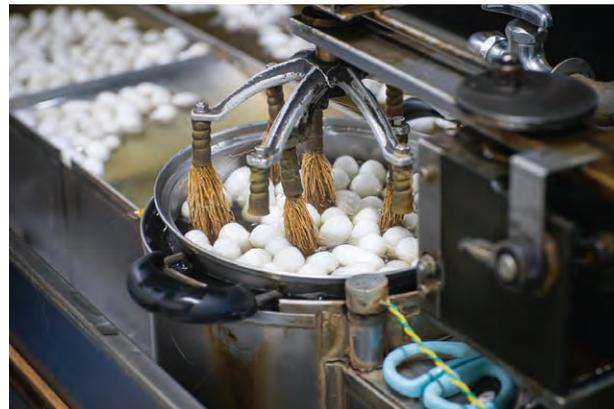
Pour que les cocons soient plus faciles à dévider ils sont ébouillantés, puis remués à l'aide de sortes de balais en branchages qui permettent d'accrocher le bout du fil.
